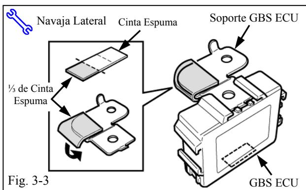
(c) Corte y Aplique  $\frac{1}{3}$  de Cinta Espuma al Soporte de Escuadra del GBS ECU como se muestra en la imagen. (Fig. 3-3)
